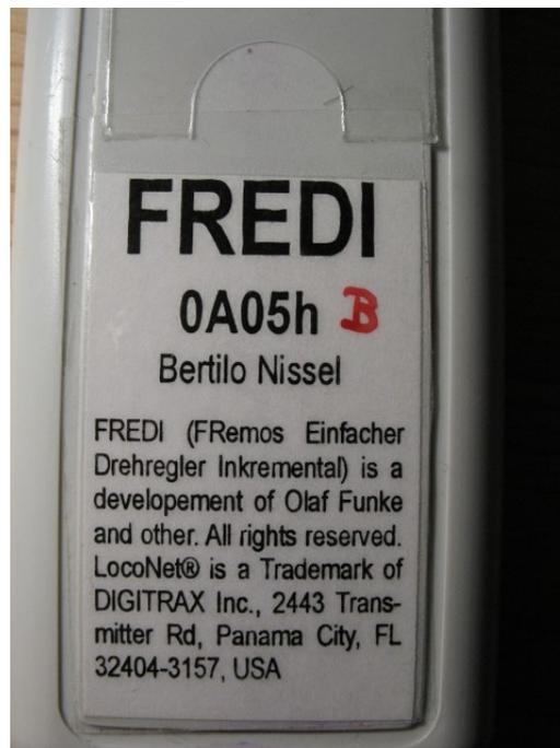
Abbildung 11 Kennzeichen „B“ für FREDi mit keramischen Kondensatoren
