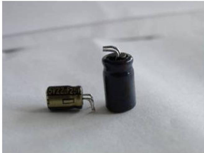
Abbildung 3 Elkos mit abgewinkelten und verzinnten Pins
